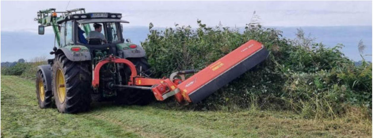
01.10.2021: Das Entfernen der auf 1,5 km ausgedehnten Brombeergebüsche erfolgt mit Traktor und Seitenmulcher
