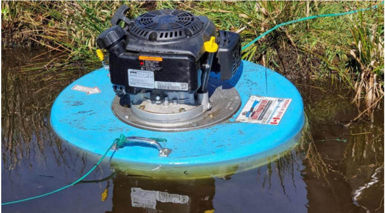
20.04.2021: Getestet wurde im April auch eine kanadische Schwimmpumpe, die eine Leistung von fast 100 m<sup>3</sup> Wasser pro Stunde schafft und daher binnen kürzester Zeit eine ausgetrocknete Wiese unter Wasser setzen kann.
